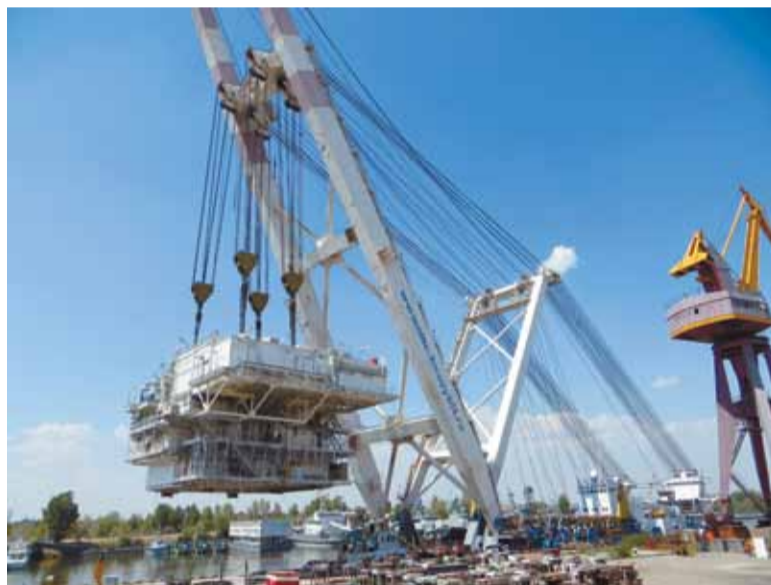
Погрузка подвышечного основания и буровой вышки для ЛСП-1
